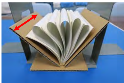
矢印は段ボールの波形の中芯の方向
